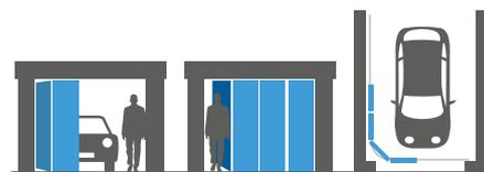
En neuf comme en rénovation, la porte de garage latérale se déplace le long d'un mur intérieur, c'est une solution idéale pour les garages avec peu de hauteur.
